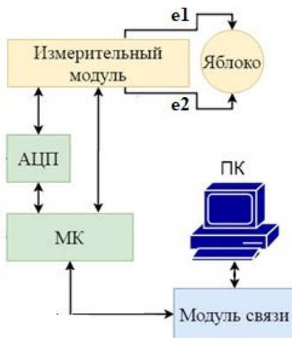
Рис. 1. Структура прибора для контроля зрелости яблок
